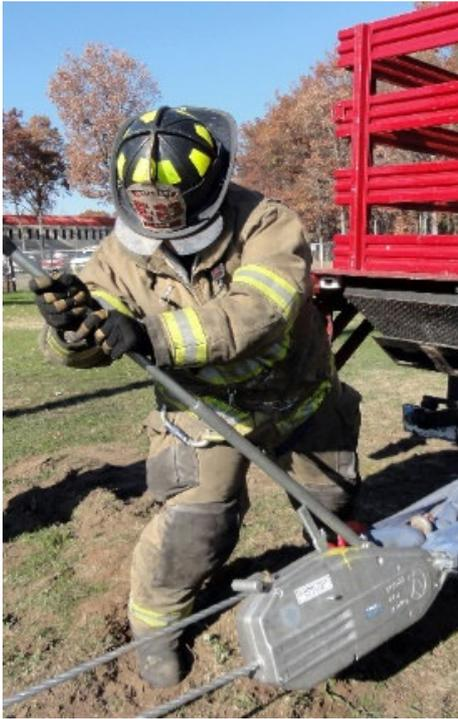
Tirfor 是一款用途广泛的设备。其设计符合人体工程学，重量轻，便于运输、安装和操作。它可以在各种配置和情况下使用，能够使用较长的绳索进行作业。Tirfor 可以精确到毫米地拉动、提升和定位负载。使用滑轮组(\*)可以成倍增加其载荷能力。
